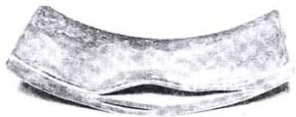
รูปที่ 1 ภาพตัดขวางของแผ่นเหล็กกล้าในหน่วยปฏิบัติการทางปิโตรเลียมที่มีรอยบวมและแตกออกเนื่องจากไฮโดรเจน (Fontana, 1986)
