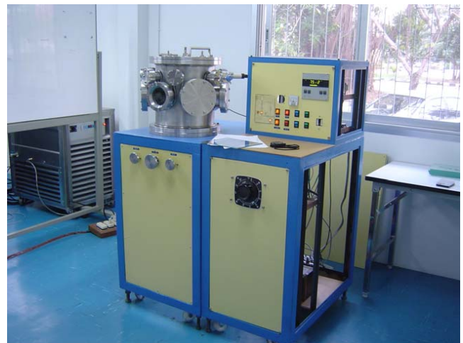
ภาพที่ 2 เครื่องเคลือบในสุญญากาศระบบระเหยสารเดิมที่นำมาพัฒนาต่อเป็นเครื่องเคลือบระบบ ดีซี แมกนีตรอน สเป็คเตอรึง แบบคาโทดคู่ในงานวิจัยนี้
