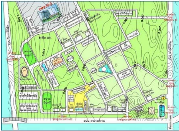
ภาพที่ 8 ระดับค่าความเข้มข้นเฉลี่ยของแก๊สไนโตรเจน-ไดออกไซด์เฉลี่ย 1 ชั่วโมง สูงสุดอันดับ 2 บริเวณมหาวิทยาลัยเกษตรศาสตร์
