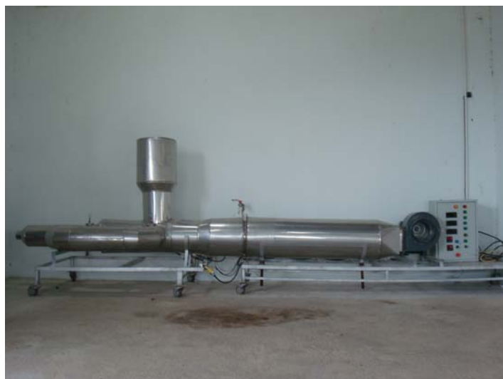
ภาพที่ 1 อุปกรณ์ทดสอบการอบแห้งชั้นบางของผลผลิตทางการเกษตร (ที่มา : มารีนา และคณะ, 2551)
