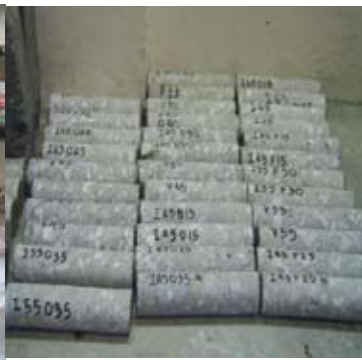
ค) การเจาะและตัดตัวอย่างคอนกรีตเพื่อทดสอบการแทรกซึมของคลอไรด์
