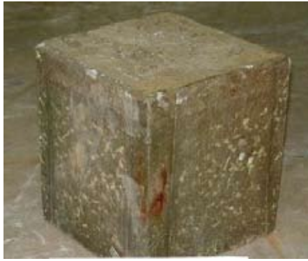
ก) ตัวอย่างคอนกรีตและตำแหน่งที่ฝังเหล็ก
