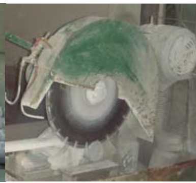
ค) การเจาะและตัดตัวอย่างคอนกรีตเพื่อทดสอบการแทรกซึมของคลอไรด์
