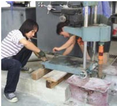
ค) การเจาะและตัดตัวอย่างคอนกรีตเพื่อทดสอบการแทรกซึมของคลอไรด์
