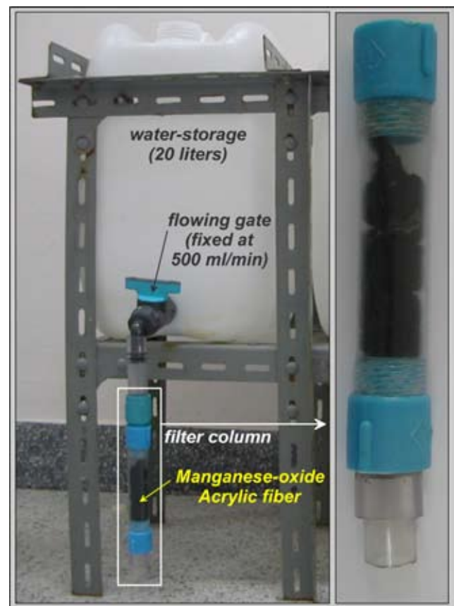
ภาพที่ 2 ภาพถ่ายระบบกรองน้ำที่ใช้ในการเก็บตัวอย่างเรเดียม-226 ในการศึกษาครั้งนี้ ประกอบด้วยถังบรรจุตัวอย่างน้ำปริมาตร 20 ลิตร วาล์วควบคุมอัตราการกรอง และชุดกรองบรรจุตัวดูดซับเส้นใยอะคริลิกแมงกานีสออกไซด์ประสิทธิภาพสูง
