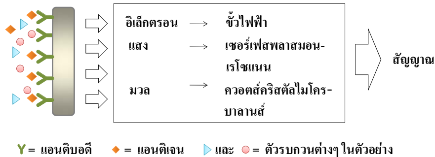
ภาพที่ 1 หลักการของอิมมูโนเซนเซอร์ แอนติเจนจับกับแอนติบอดี ผลทำให้สมบัติทางกายภาพและทางเคมีเปลี่ยนแปลง และตรวจวัดการเปลี่ยนแปลงดังกล่าวด้วยตัวตรวจวัด (Luppa et al. , 2001)
