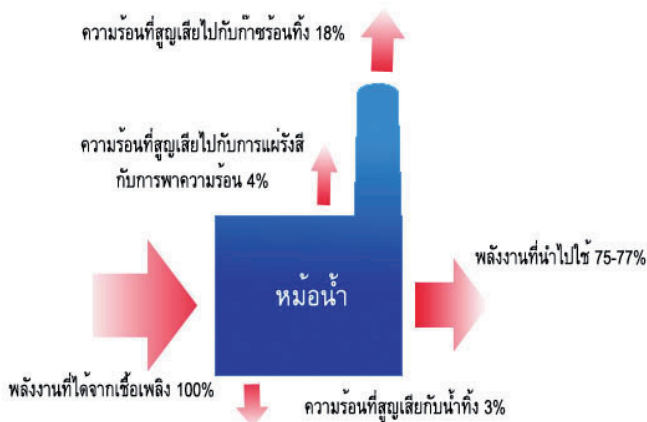
ภาพที่ 1 ระบบการสูญเสียความร้อนทิ้งของหม้อน้ำ ที่มา : Massimo Gobbi. (2011).
