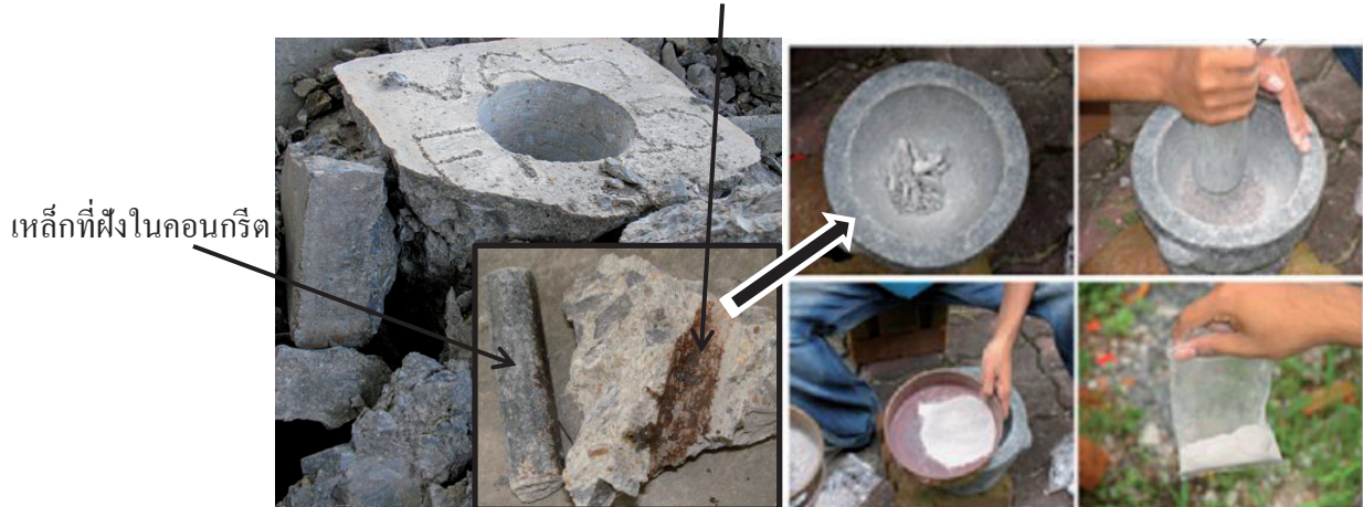
ภาพที่ 2 การเตรียมตัวอย่างเพื่อทดสอบปริมาณคลอไรด์ในคอนกรีต
