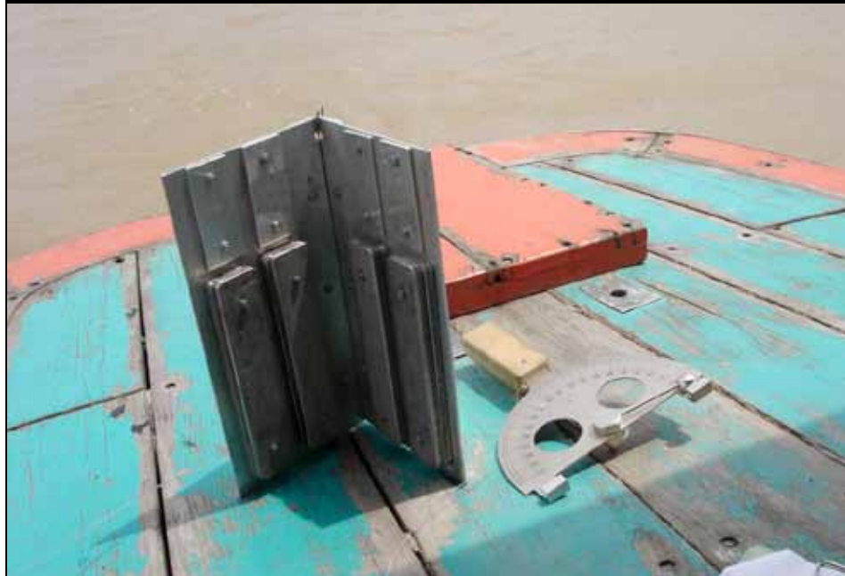
ภาพที่ 3 เครื่องวัดความเอียงของสายเอ็น 2 รูปแบบ ด้านซ้ายเป็นเครื่องวัดมุมจากประเทศญี่ปุ่น ส่วนด้านขวาสามารถซื้อได้ตามร้านช่าง (คลองถม เป็นต้น) รูปล่างเป็นเครื่องวัดกระแสน้ำที่ใช้ก้อนน้ำหนักรวม 4 กิโลกรัม (ก้อนน้ำหนัก 8 ก้อน)
