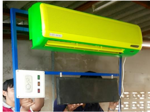
ภาพที่ 5 การติดตั้งคอยล์เย็นและถังน้ำเย็น
