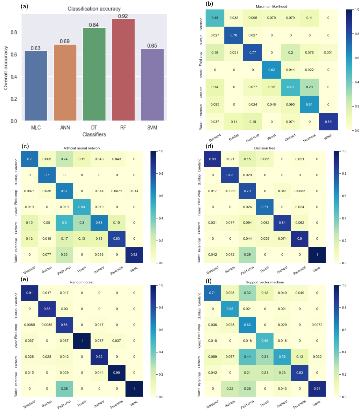
ภาพที่ 6 OA ของวิธีการจำแนกแต่ละวิธี (a) และการทดสอบความถูกต้องด้วยเมตริกซ์ความสับสนของ (b) ความน่าจะเป็นสูงสุด (c) ข่ายประสาทเทียม (d) ต้นไม้ตัดสินใจ (e) ป่าสุ่ม และ (f) ซัพพอร์ตเวกเตอร์แมชชีนด้วยค่าความแม่นยำเฉพาะในส่วนที่แบบจำลองทำนายถูก (precision)
