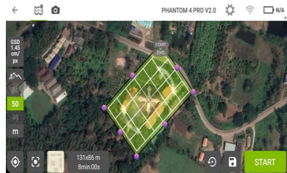
ภาพที่ 5 การกำหนดขอบเขตพื้นที่แบบสี่เหลี่ยมและบินแบบ Cross ได้ในโปรแกรม Pix4DCapture บริเวณวังเจ้าเมืองพัทลุง
