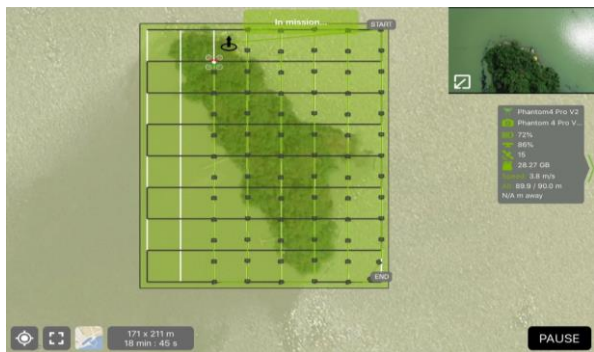
ภาพที่ 2 การวางแผนแนวมบินและการตั้งค่าในโปรแกรม Pix4DCapture บริเวณเกาะกระ
