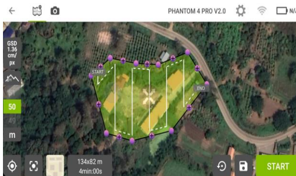
ภาพที่ 4 การกำหนดขอบเขตพื้นที่ได้แต่บินแบบ Cross ไม่ได้ ในโปรแกรม Pix4DCapture บริเวณวังเจ้าเมืองพัทลุง
