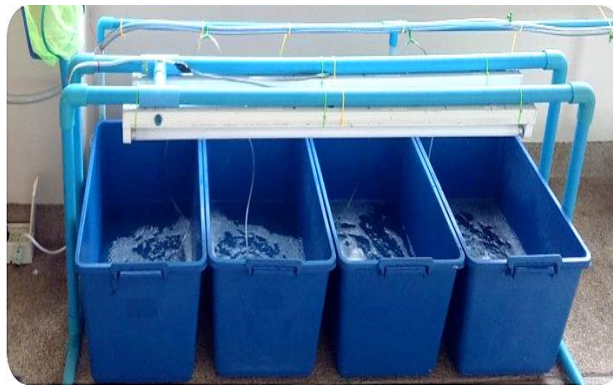
ภาพที่ 1 ระบบทดลองการเพาะเลี้ยงสาหร่ายพวงองุ่นแบบปิด
