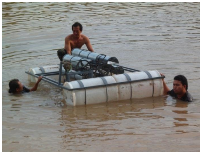
ภาพที่ 4 ทดสอบความสมดุลเครื่องผลิตไฟฟ้า
