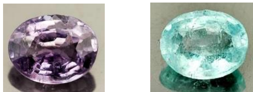
ก) ทวีร์มาลีนก่อนเผา ข) ทวีร์มาลีนหลังเผา
