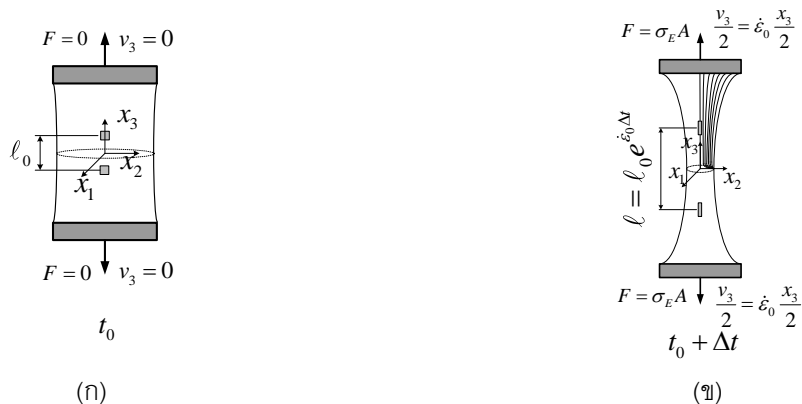
ภาพที่ 4 แสดงระยะทางระหว่างก่อนอนุภาคของไหลในการดึงทิศทางเดียว ที่ถูกดึงด้วยอัตรายืดดึงคงที่ \dot{\epsilon}_0 (ก) ก่อนอนุภาคของไหลที่เวลา t_0 และ (ข) ก่อนอนุภาคของไหลที่เวลา t_0 + \Delta t เส้นที่มุมบนขวา แสดงเส้นทางการไหล (Streamlines) ในเนื้อวัสดุ
