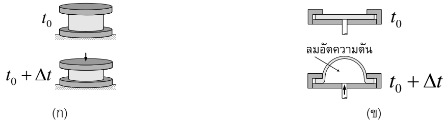
ภาพที่ 9 แสดงการทดสอบการยืดดึงสองทิศทาง (Biaxial stretching flow) ด้วย (ก) วิธีกดอัด (Squeezing flow) และ (ข) วิธีเป่าแผ่นฟิล์มให้พองลม (Bubble inflation method)
