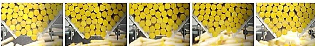
ภาพที่ 4 ลักษณะการขัดตัวกันของวัสดุเม็ด ภายใต้การสั่นแนวตั้งด้วยความเร่งไร้มิติเท่ากับ 0.011g ที่เงื่อนไขขนาดมุมฮอปเปอร์( \theta ) เป็น 10^\circ และ 50^\circ และขนาดช่องปล่อยฮอปเปอร์เทียบกับขนาดเส้นผ่านศูนย์กลางของวัสดุเม็ด ( D/d ) เป็น 2 และ 3
