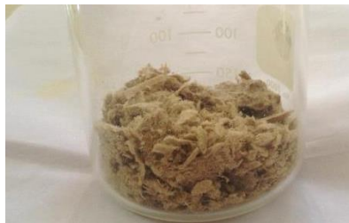
ภาพที่ 2 เซลลูโลสฟอสเฟตจากเปลือกข้าวโพดที่สังเคราะห์ขึ้น
