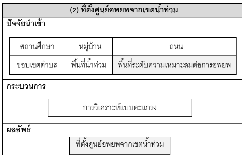
ภาพที่ 2 ข้อมูลพื้นฐานที่ใช้การวิเคราะห์พื้นที่ที่เหมาะสมสำหรับการอพยพน้ำท่วม
